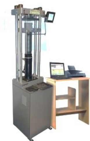
1-rasm. IP-1A-1000 PK sinov mashinasining umumiy ko’rinishi.
