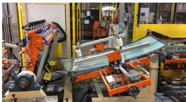
3-rasm. Magna Internationalda old oynak vakuumlash jarayoni.
