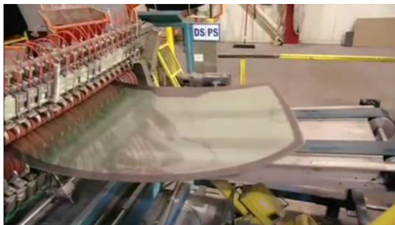
4-rasm. Pilkingtonda old oynak vakuumlash jarayoni.
