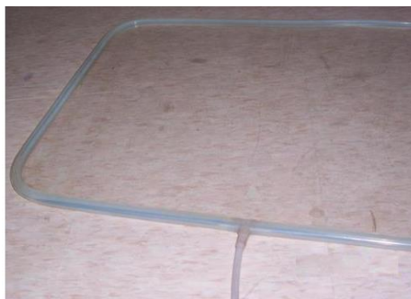
2-rasm. Vakuumlash uchun oynak atrofiga vakuum xalqani o‘rnatish
